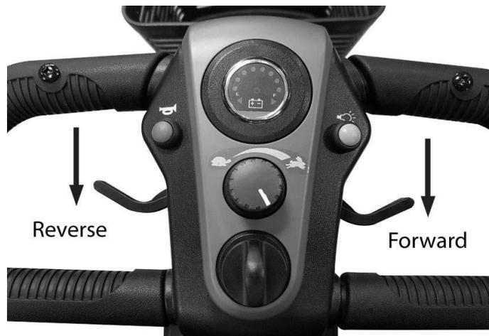
La velocidad y la dirección del patinete se controlan mediante la palanca de movimiento. Las flechas que se muestran en la imagen de arriba muestran la dirección en la que se moverá el scooter cuando se accione la palanca como se indica.
